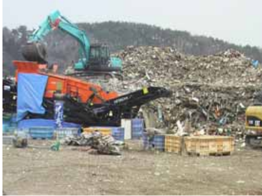
図 2.2 一次仮置場での選別（左：混廃の粗選別、右：ふるい下土砂の再分級）（宮城東部）
