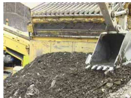
図 2.3 一次仮置場での選別（津波堆積物の処理）（宮城東部）
