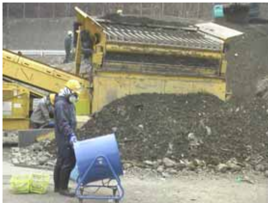
図 2.3 一次仮置場での選別（津波堆積物の処理）（宮城東部）
