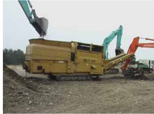
図 2.2 一次仮置場での選別（左：混廃の粗選別、右：ふるい下土砂の再分級）（宮城東部）
